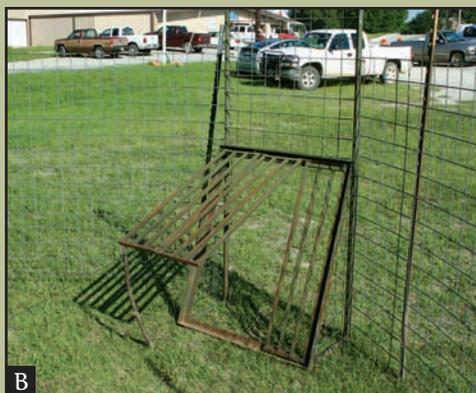
Las puertas de vaivén requieren resortes para cerrarse (A). Las compuertas levadizas se pueden colocar en una posición abierta como una puerta tipo guillotina y, una vez disparada, más marranos pueden empujar camino hacia el interior de la trampa (B). Al ser disparada, la puerta se cerrará pero todavía permitirá que entren más marranos.
